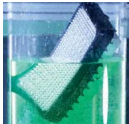
→ Essai de résistance à l'immersion et contrôle d'étanchéité
